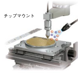
③ チップマウント時のシート剥離
